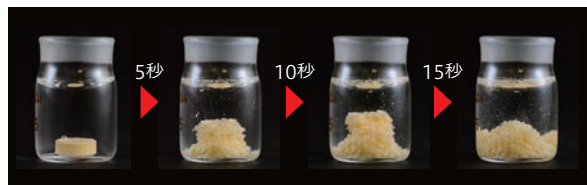
非常に素早く崩壊するコストを抑えた直打製法
