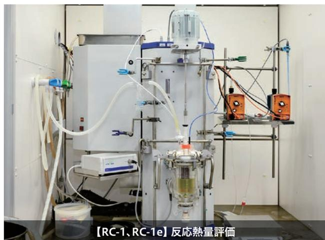
【RC-1, RC-1e】反応熱量評価
