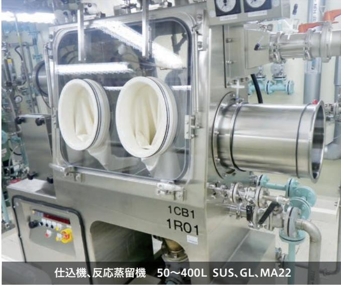
仕込機、反応蒸留機 50~400L SUS、GL、MA22
